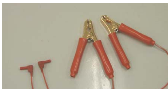
Figura 2-Cables para medición de tensión
